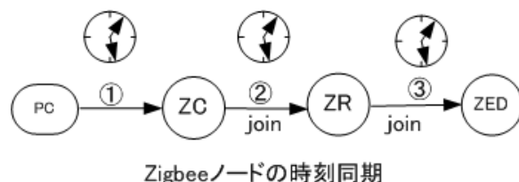
図 21 ZigBee ノードのクライアントサーバ時刻同期方式
