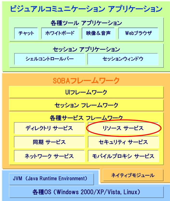
図 4-1.1 SOBA フレームワークの構造 (図中の赤線の範囲が主な改良箇所)
