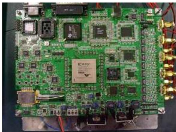
図 4-4-3-2 偏波モード分散補償モジュールの写真
