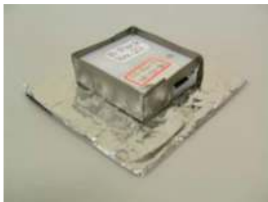
図 4-1-3-4 磁性シートとアルミ板に取り付けた Bluetooth 通信装置
