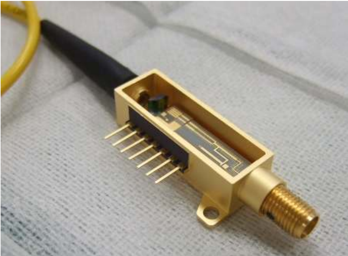
図 4-3-15 PD アレーモジュールの全体写真
