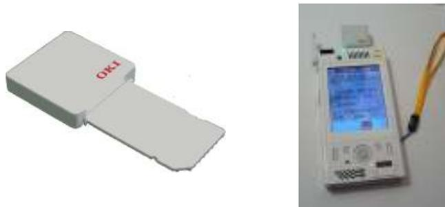
図1 SDカードインタフェースのZigBeeノード（左）と同カードを実装したユビキタスコミュニケータ（右）
