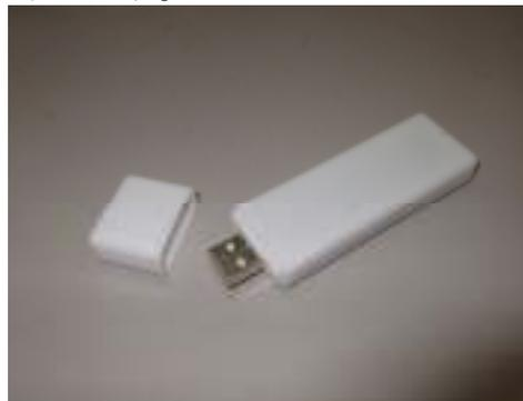
図3 USB インタフェース ZigBee ノード
