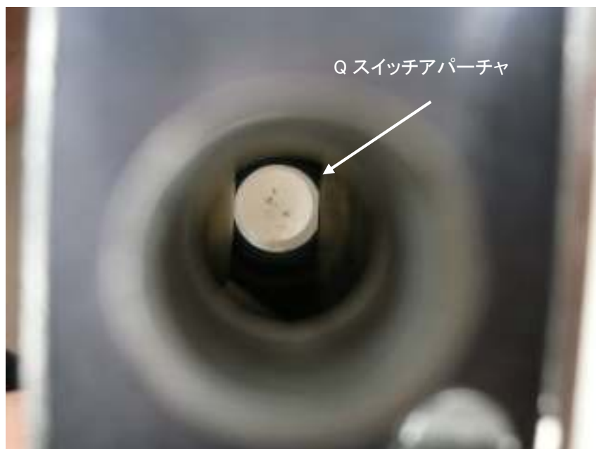
図 4.3.5.2 損傷した Q スイッチ写真
