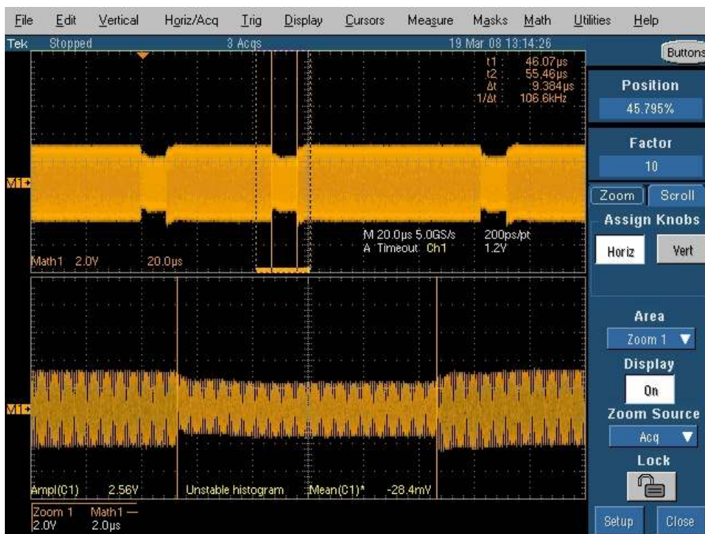
図 4-1-1-11 : 13.56MHz システム出力 10%変調 変調幅
