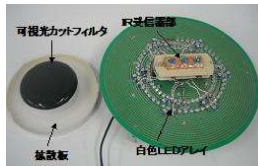
図 3-A-8 照明アクセス装置の内部構成 左：光学フィルタ、右：基板前面
