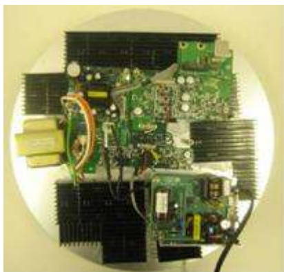
図 3-A-9 照明アクセス装置の背面外観
