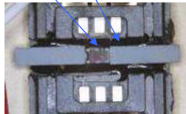
図8-2 MI素子+集磁構造(先行実験)
