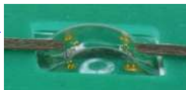
図11-8 集磁実装基板1を用いてのMI素子両端に集磁体構造を近接配置した状態 (MI素子はポッティング樹脂に覆われて見えない)
