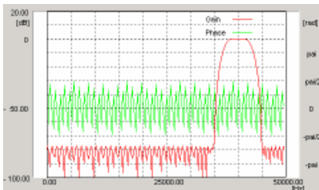
図14-3 サンプル周波数100KHz時、タップ数100のFIRにより40KHzBPFを構成した場合の特性をシミュレートした例
