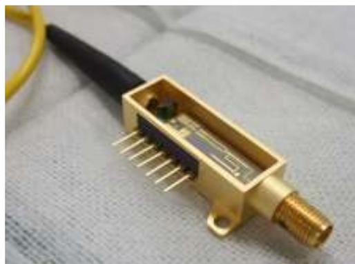
図 4-2-2: PD アレーモジュールの全体写真
