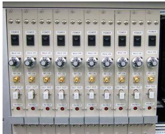
図 4-3-3: マイクロ波-光変換器の試作装置概観写真(波長別に 10 台モジュールで構成)
