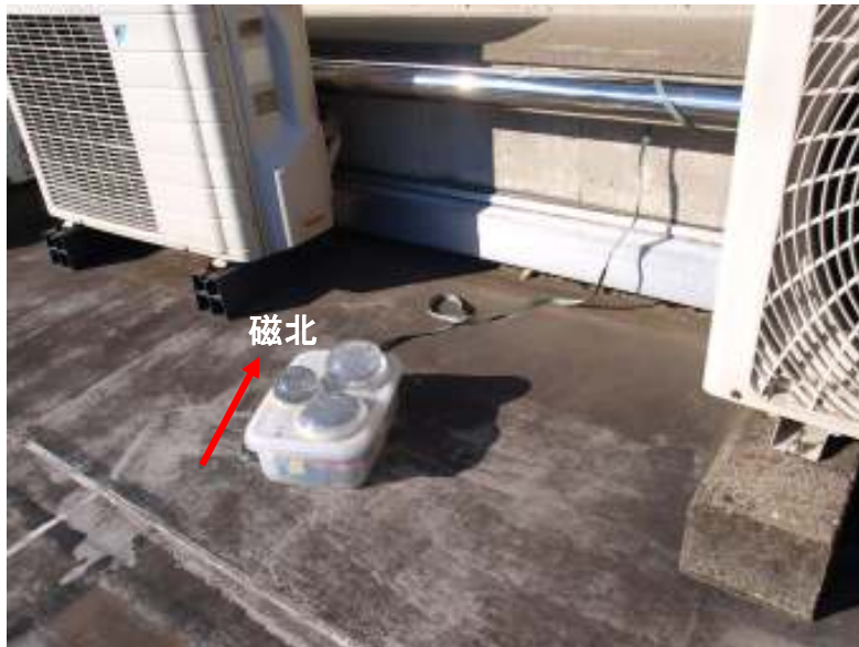
図 8：発電素子一体型アクティブタグ評価装置設置状況
