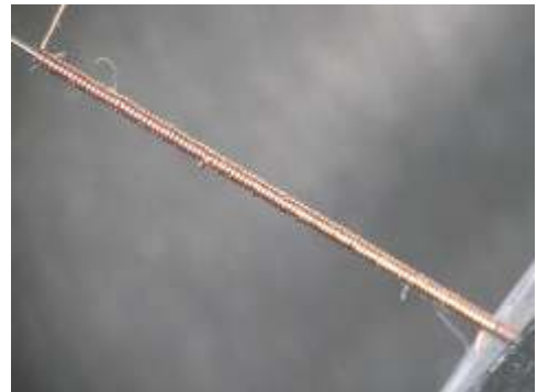
図 12-18 MI ワイヤへの手巻き加工 (参考)
