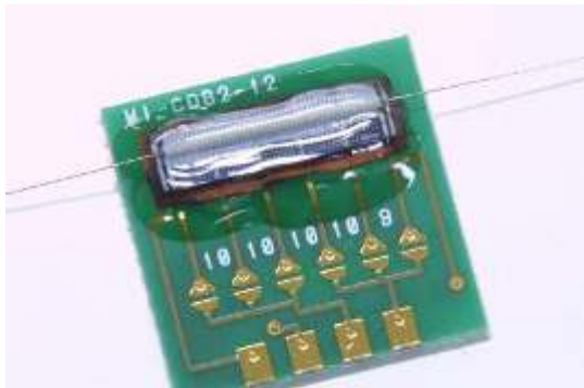
図 12-17 MI ワイヤ用チップへの MI ワイヤ実装
