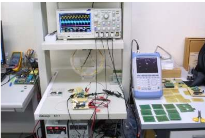
図 15-14 DSPボードとデジタルフィルタ評価システム装置と上記時計などを配置して評価を行っている状態
