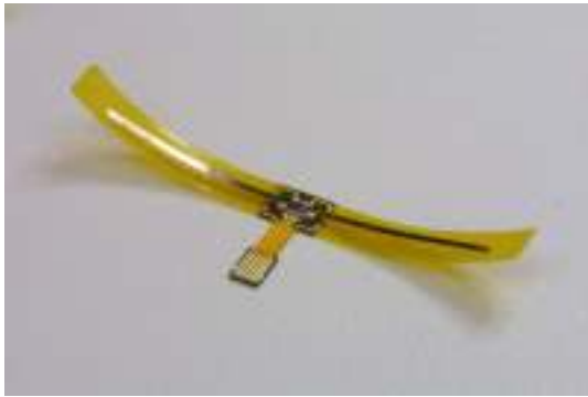
図15-9 Type-Aに1mm×2mmチップ 実装 0.8mm×22mmアモ箔帯付き
