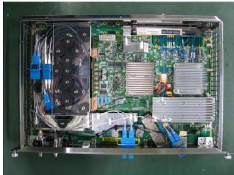
図 4-1-4-2 試作した分散フリートランスポンダ
