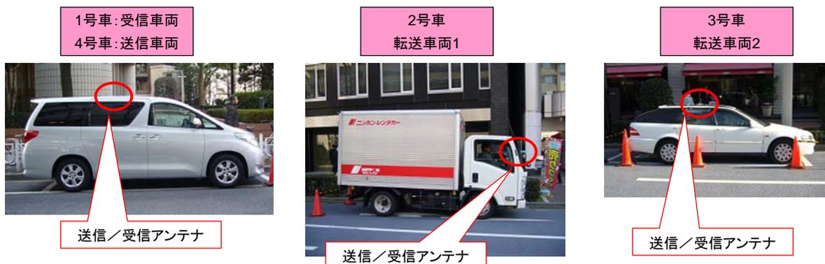
図エ(2-3) 通信実験における実験車両寸法とアンテナ設置位置
