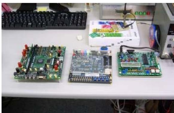
図14-1 導入した各種DSP、FPGA評価キット
