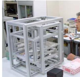
図11-2 無磁場空間装置および、それを用いての直流磁界感度測定の様子
