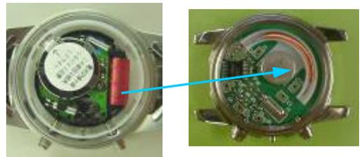
図6-1 コイルアンテナ時計筐体内実装の様子
