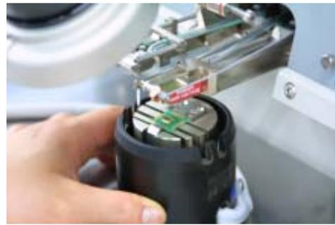
図11-4 ボールボンダでの試料組立の様子
