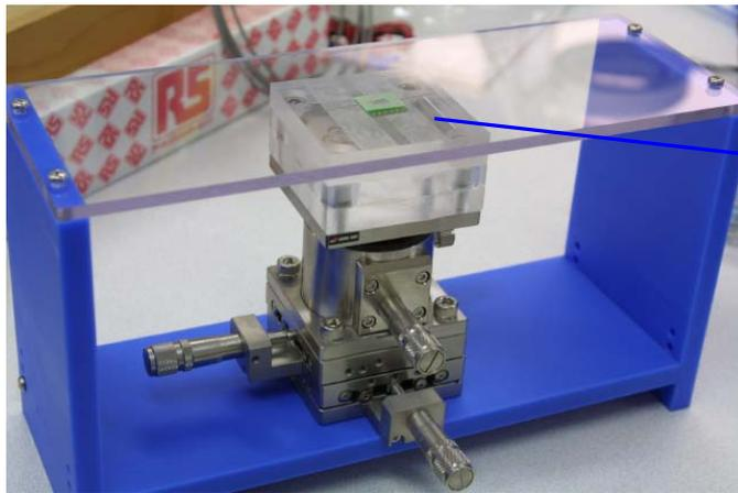
図11-11-(a) マイクロステージにて位置合せ中の試料
