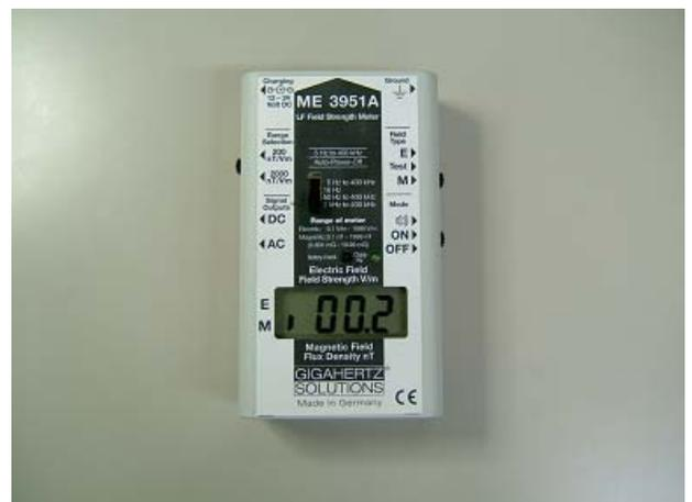
図 14-29 磁界強度計(山林の様なノイズの少ない状況下では正確な値を直読可能)
