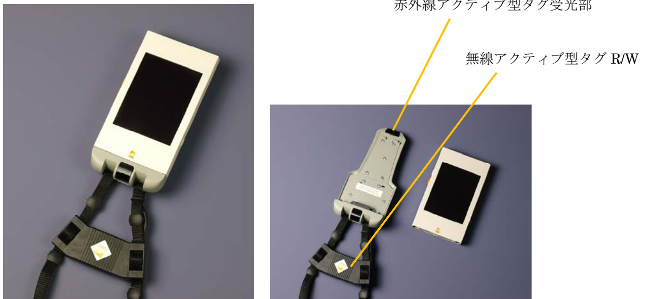
図 4-3-3-2 ハードウェアプラットフォーム (Type B) 本体並びにアタッチメントを接続した状態 (左) 本体とアタッチメントを分解した状態 (右)
