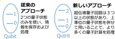
第一励起状態より高エネルギーに存在する上準位の量子状態も併せて用いることで、より高速の量子回路操作が可能であることを示しました。
