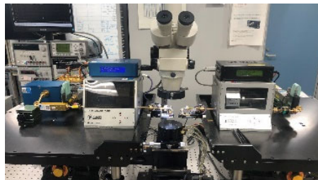
デバイス特性評価を行う高周波計測装置 (50~110 GHzの出力特性)
