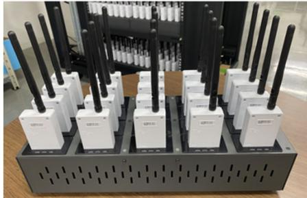
920MHz帯チャープスペクトル拡散によるパルス符号を用いた500台の送信機での実証実験に成功しました。この無線通信デバイスには、外部機器を接続可能なインターフェースを用意しており、センサーネットワークなど様々な用途に利用することができます。
