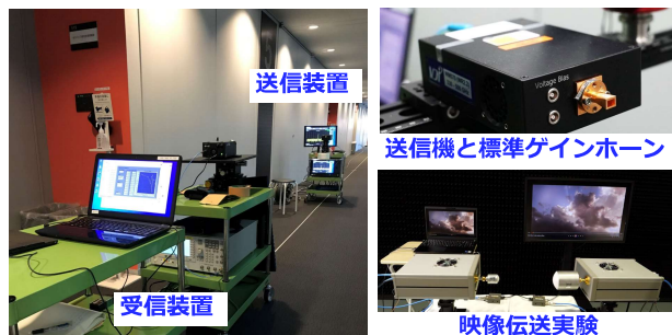
テラヘルツ帯の電波を無線通信に使用するために必要な電波の伝わり方に関する基礎データの取得 300 GHz帯 屋内電波伝搬特性の測定
