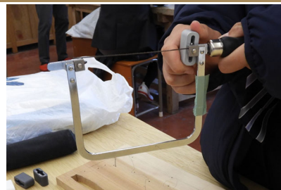
美術工芸の授業で使用する糸鋸刃の取り付け金具の増し締め補助器具を共同開発中 授業中の刃の脱落防止による効率アップを目指す
