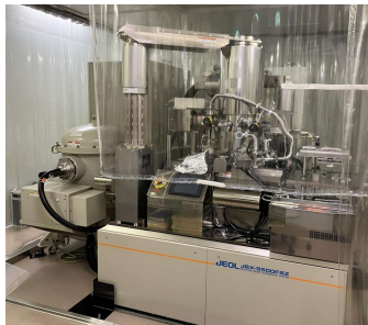
100 nm以下の微細T型ゲートを作製する電子ビーム描画装置
