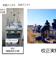
整備した地上校正装置と地上校正実験 (月2回実施)
