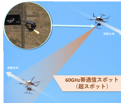
60 GHz帯データ伝送中のドローン及び 形成される通信スポットの模式図
