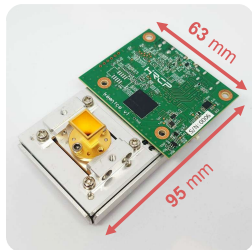
IEEE802.15.3e準拠SoC (System on Chip) 外観と主な仕様 (協力: 高速近接無線技術研究組合)
