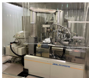
100 nm以下の微細T型ゲートを作製する電子ビーム描画装置
