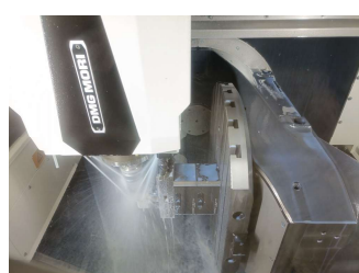
5軸機により可能になった側面加工 (南極LNA用マウント金具)
