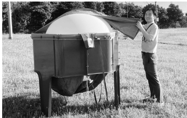
差分吸収ライダーによる水蒸気測定精度検証のために 気球に取り付けたラジオゾンデ（気象センサー）を放球する様子
