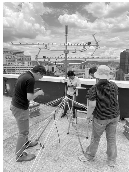
水蒸気量観測のための 地上デジタル放送波受信アンテナの設置風景 (國立陽明交通大學 (台北市))
