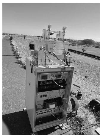
図4 能動型レーダー校正器 (Active Radar Calibrator; ARC)
