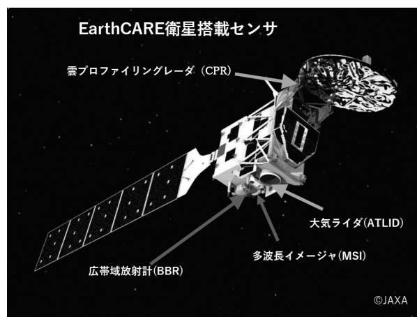
EarthCARE 衛星軌道上イメージと搭載センサ
