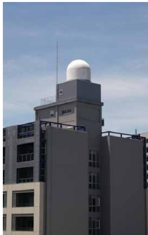
大阪大学吹田キャンパス(E3棟屋上)に 設置されたフェーズドアレイ気象レーダ
