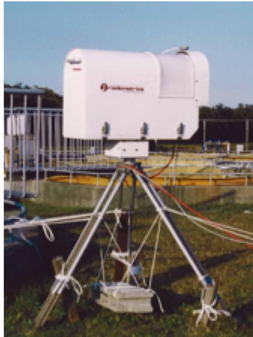
図 2.26: NICT で運用する水蒸気ラジオメータ Radiometrics 社 WVR1100 型。本体の下部に付属している白い小さな箱はラジオメータのアンテナを任意の仰角・方位に向けるための AZEL 追跡ドライバ。
