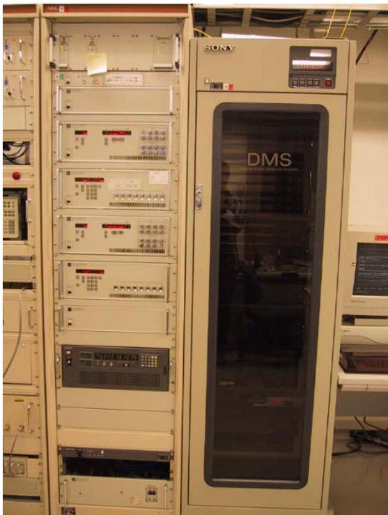
図 2.21: K4/KSP システム。左側に局部発振器、ビデオコンバータ、AD サンプラがあり、右側は自動テープ交換ロボットである。
