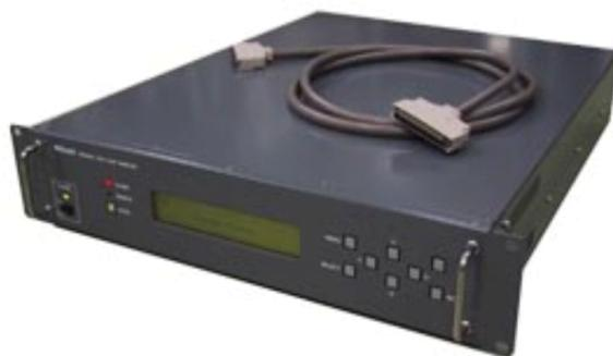
図 5.18: 多チャンネル AD サンプリング装置 ADS2000。
