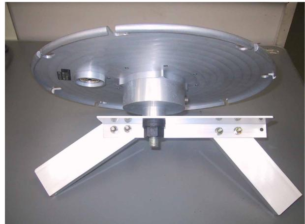
図 5.16: GPS アンテナと取り付け用の治具
