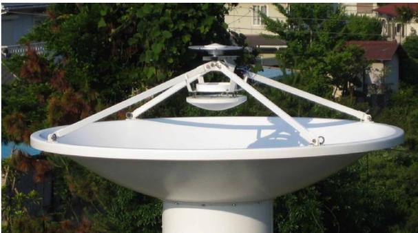
図 5.15: CARAVAN2400 の副鏡上に設置された GPS アンテナ (2006 年 7 月)
