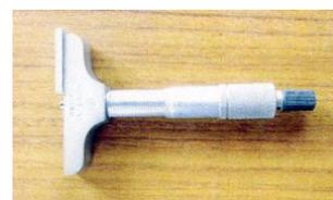
図 B.2: パネル高測定に使用するデプスマイクロメータ。
