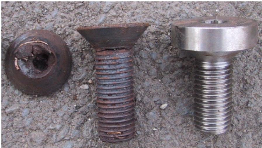
図 4.10: AZ レールボルト。左から折損したボルトの頭部、従来型のボルト、そして一番右側が 2000 年から使用を開始した強化ボルト。
