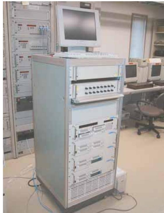
図 2.22: K5/VSSP システム。ラック組込型の PC4 台により 256Mbps のデータレートで記録が可能である。
