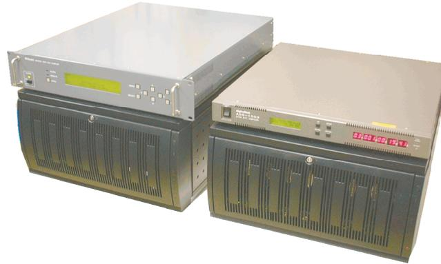
図 2.24: K5/VSI システム。左上が 16ch、64Mbps/ch のサンブラ ADS2000、右上が 1ch、1024Mbps/ch のサンブラ ADS1000 である。それぞれの下の PC のハードディスクは 2TB の記録容量を持つ。
