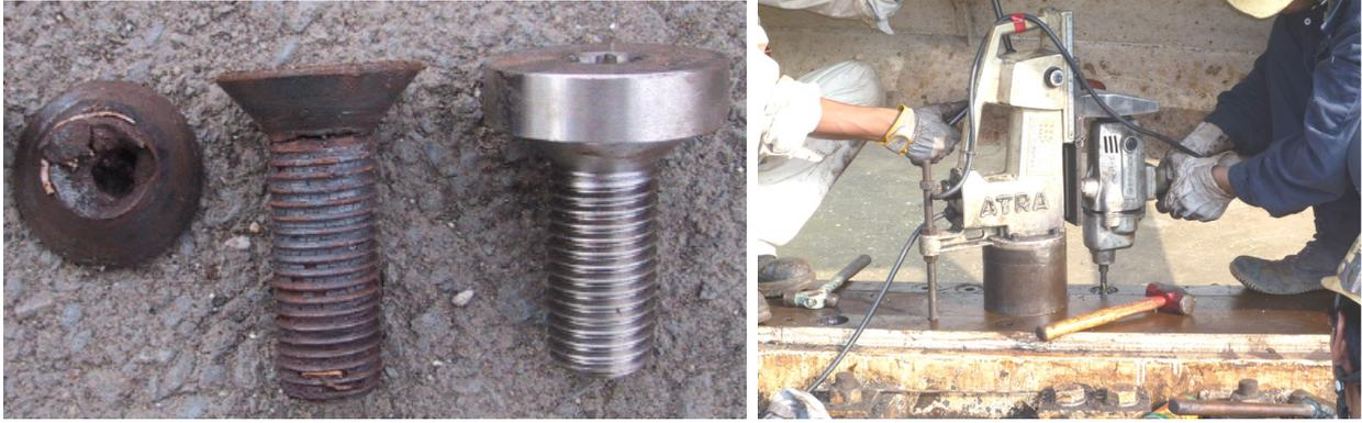
図 3.16: (左写真) 折損ボルトと新ボルト。 左から、折損したボルト、折損する旧ボルト、折損する首の部分を強化した新ボルトである。(右写真) 折損したボルトをドリルで除去中。 AZ レール上に磁気吸着ボール盤を設置、折れて残ったボルトをドリルでくりぬいた。ボルトは固いため、小さいドリルから徐々に太くして穴を大きくした。また通常のドリルは歯がすぐに鈍るため、現場で歯の研磨も繰り返した。途中から超硬ドリルを使用した。
