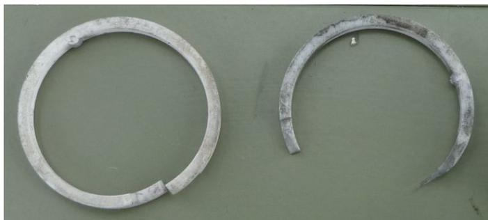
図 3.11: 冷凍機のシール。左が正常なシール。右が摩耗して一部が欠損しているシール。
