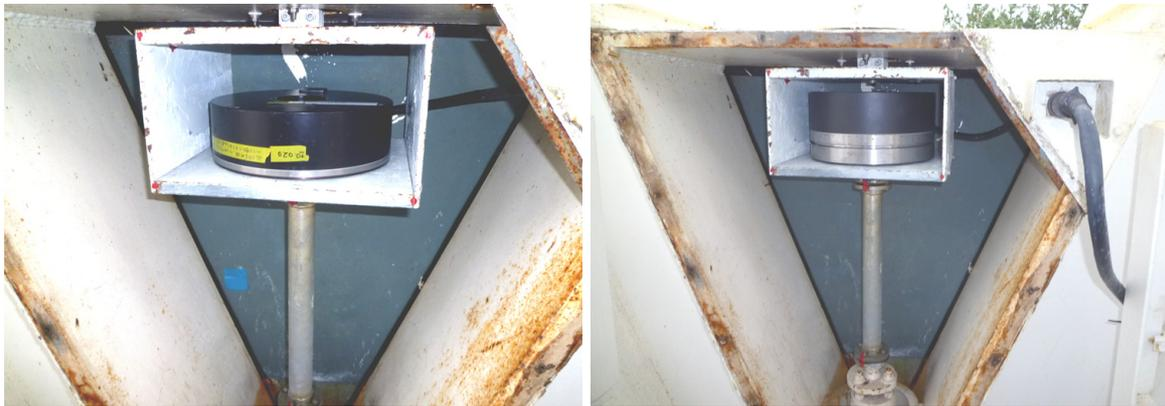
図 3.21: (左写真) 交換前の AZ エンコーダ光学ユニット (S/N 4195)。取り付け箱の中の円柱形が光学ユニットで、その下は地上側基準軸である。(右写真) 交換後の AZ エンコーダ光学ユニット (S/N 062248)。同型が入手できなかったため、同等品として入手した予備機は高さが 2 倍となったが、どうにか収納箱に納められた。
