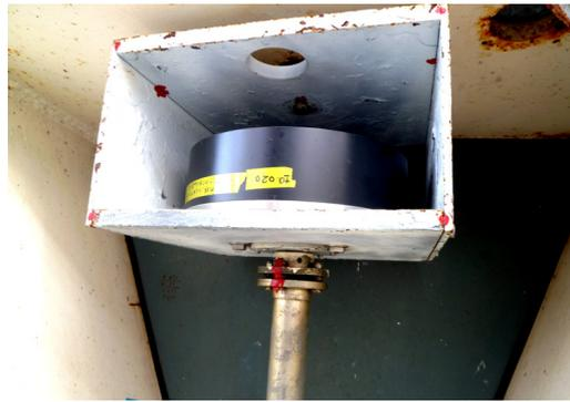
図 3.19: AZ エンコーダ軸固定部の緩み。四角い箱とエンコーダが固定され、その下のシャフトが地上側の基準軸で、エンコーダ中心にある回転部と接続されている。エンコーダとシャフトの固定部に僅かな緩みがあったため、増し締めした。地上側基準軸は地下室から約 6.6m ほど高さのある自立柱のため、地震動で大きく揺らされたためこの緩みが生じたと推測される。
