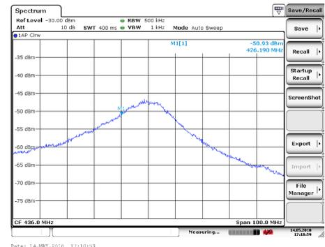
図 2.24: 5.8GHz 帯受信機の周波数特性。帯域幅は約 14MHz である。
