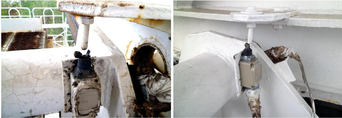
図 3.14: (左写真) 破損したストアラインスイッチ。 アンテナ EL 駆動時には前後にピンが動くが、地震時には通常動かない左右に動いたため、ストアライン検出用スイッチのローラプランジャ形のアクチュエータ部分が破損した。(右写真) 交換後のストアラインスイッチ。 正しいストアピン挿入位置直前の状態である。EL 軸が回転、上部のボルトがもう少し左に動くときアクチュエータが押され、封入されたマイクロスイッチが動作する。
