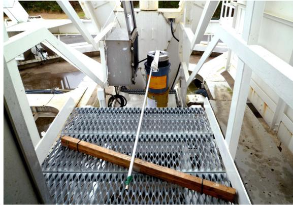
図 3.20: 予備エンコーダ光学ユニットでの動作試験。電気ユニットに予備のエンコーダ光学ユニットを接続、エンコーダ軸に 1.5m のアルミ棒を取り付け手でゆっくり回転させてテストを行い、角度飛びが発生しないことを確認した。
