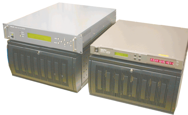
図 17: K5/VSI システム。左上が 16ch、64Mbps/ch のサンプラ ADS2000、右上が 1ch、1024Mbps/ch のサンプラ ADS1000 である。それぞれの下の PC のハードディスクは 2TB の記録容量を持つ。
