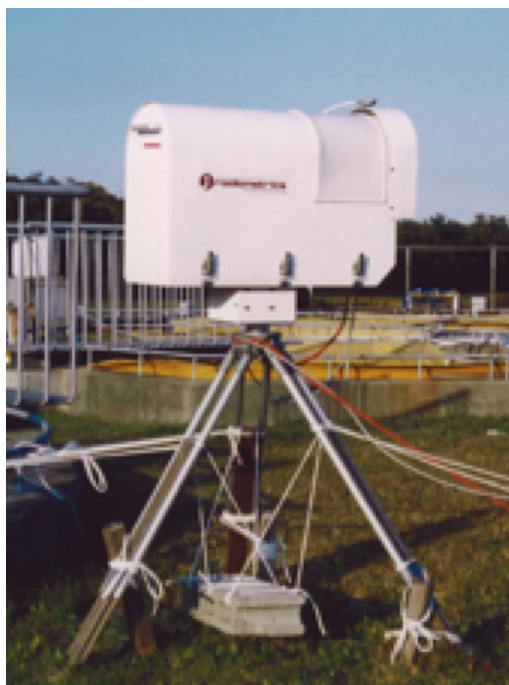
図 19: NICT で運用する水蒸気ラジオメータ Radiometrics 社 WVR1100 型。本体の下部に付属している白い小さな箱はラジオメータのアンテナを任意の仰角・方位に向けるための AZEL 追跡ドライバ。
