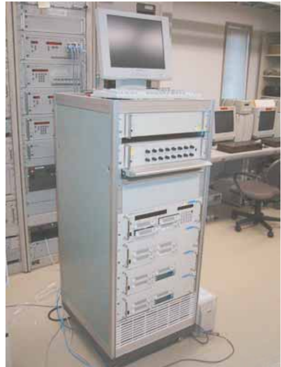
図 16: K5/VSSP システム。ラック組込型の PC4 台により 256Mbps のデータレートで記録が可能である。
