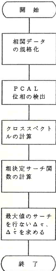
第16図 SDELY (粗決定サーチ) の処理フロー
