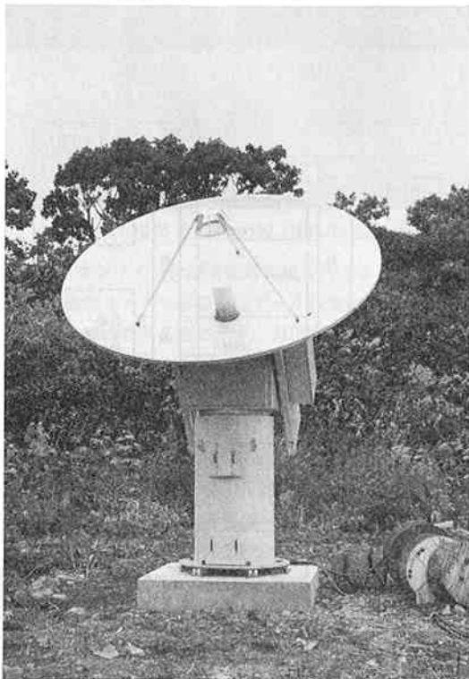
第12図 3 m アンテナ外観
