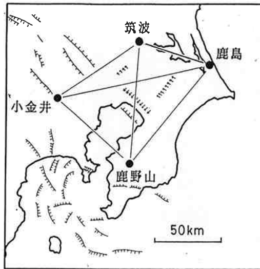
図1. MDX観測局配置(最終案)と活断層分布(50万分の1活構造図「東京」:地質調査所、1982を簡略化。
