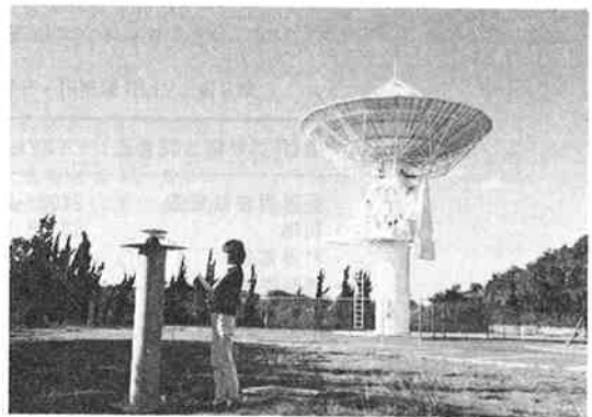
第8図 GPS受信器を上部に取り付けた地上基準柱（鹿嶋局）
