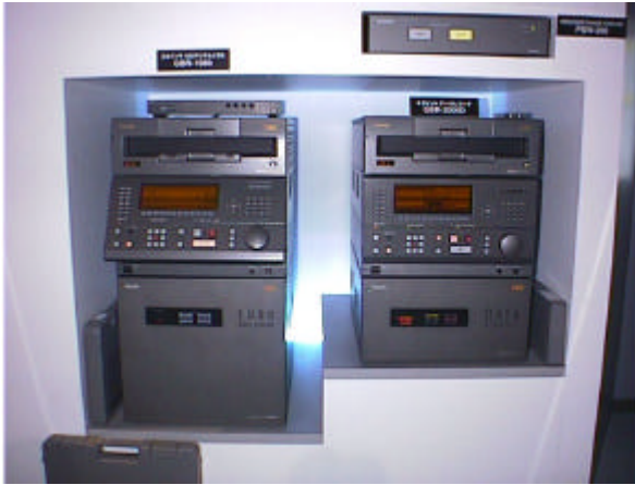
(図4: GBR2000次世代型ギガビットレコーダー) 左側のGBR1000と比べることにより小型化が判る。さらにこのレコーダーではVSIインターフェースがデッキ下側の箱に入り、そのままVSIのデータが入出力可能になる。レコーダーに外付けのVLBI用インターフェースを付けることは無くなった。さらなる小型化計画が行なわれる予定である。
