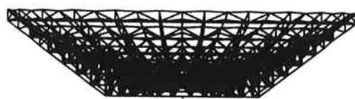
第4図 34m アンテナの FEM モデル。側面から見た場合、その外見が実際に見るアンテナと似る。
