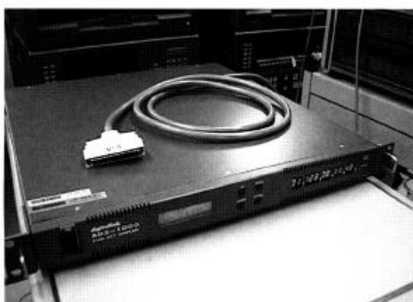
図3 VSI-H専用ADコンバータ
