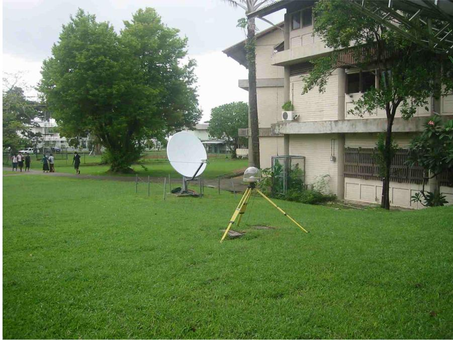
図 7: 南太平洋大学構内に設置した GPS 観測点。後方は新ポストパートナーズ計画で使用している衛星通信アンテナ
