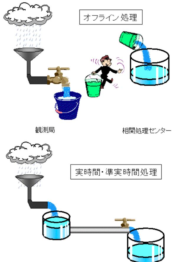
図 1 K 5 / V S S P 運用形態の模式図。オフライン処理ではバケツに見立てたハードディスクデータを直接運ぶか、 F T P で伝送する。実時間・準実時間処理では、データをハードディスクに蓄えつつネットワーク伝送する。
