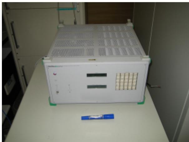
図 1: アンリツ製レーザ励起ガスセル型セシウム原子発振器の外観
