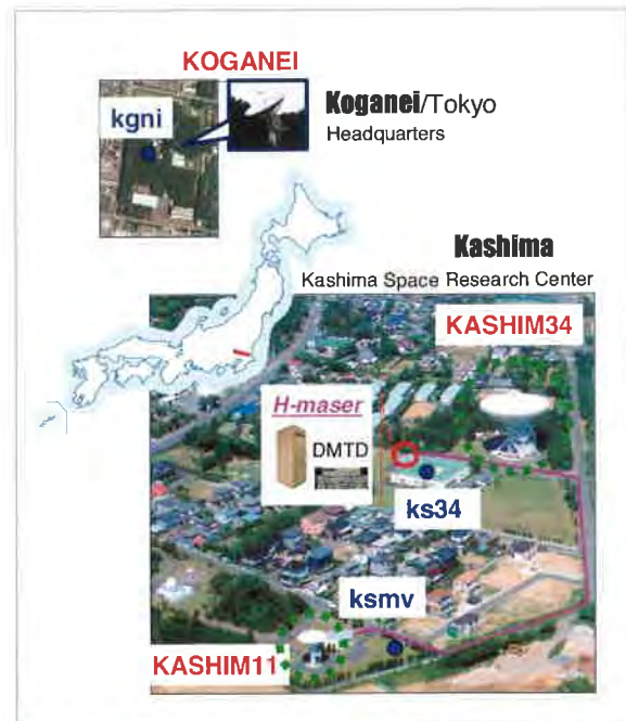
図3 鹿島局、小金井局のVLBI、GPSアンテナの配置図
