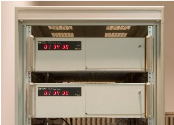
世界的に広く使用されている 商用Cs原子時計 Agilent 5071A, Microsemi 5071A
