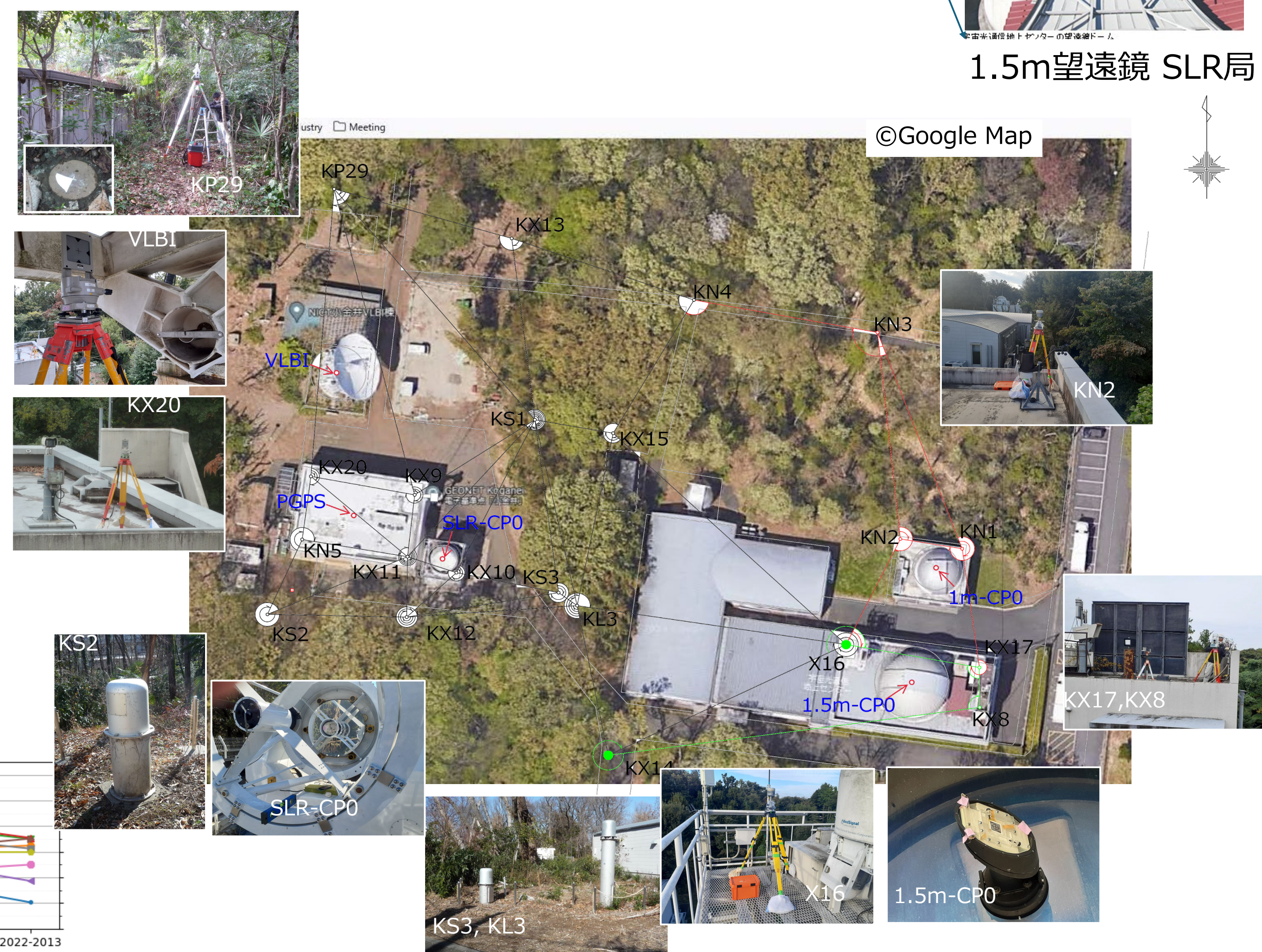
図.2 ローカルタイ測量現場の航空写真 (@Google Map). 各現場ごとの測量基準点や宇宙測地基準点の測量ターゲットの設置状況を写真で示す。
