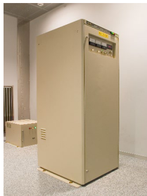
水素メーザ型 原子時計 (約6台)
