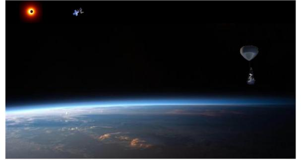
VLBI の1局として必要なすべての機能を搭載し、上空 19km 以上にて、観測システムの技術検証や静止衛星などの電波源の試験観測をおこなう。上空にて取得したデータを地上に持ち帰り分析する。
