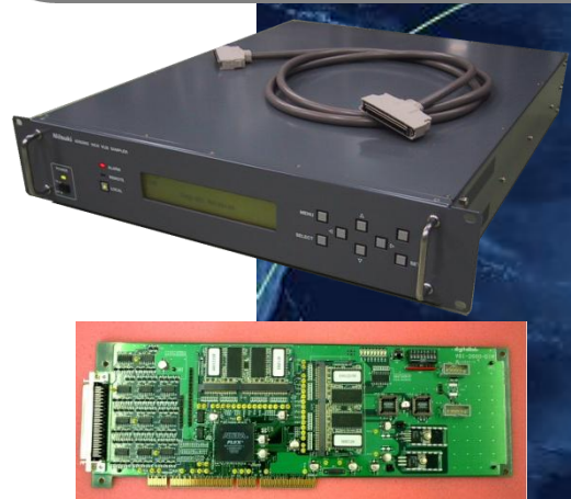
鹿島センターが開発し観測に使用した サンプラADS2000(上)とPC-VSI(下)
